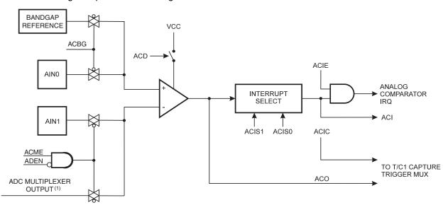
Figure 25-1. Analog Comparator Block Diagram<sup>(2)</sup>
