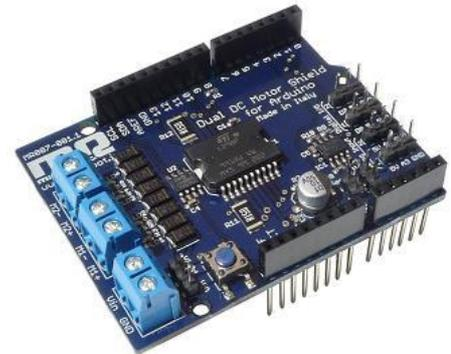
La *Dual DC Motor Shield* è una shield progettata per permettere ad una scheda Arduino di pilotare due motori DC o un motore passo-passo bipolare, controllando sia la velocità sia la direzione di ciascun canale in modo indipendente.
